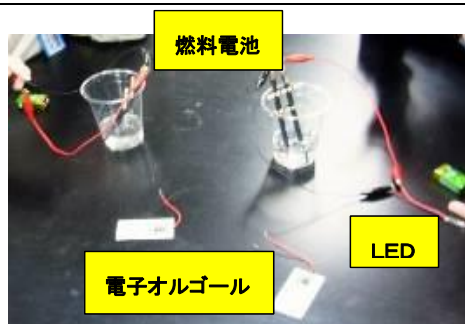
鉛筆での水素製造と発電で燃料電池体験 (水から水素を作り、水素から電気を作る)
